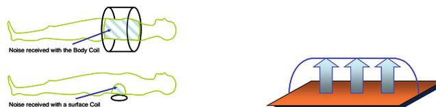
*Confronto fra bobine di volume e di superficie: l'intensità utile del segnale in profondità di una bobina di superficie corrisponde approssimativamente ai 2/3 del diametro della bobina stessa.*
